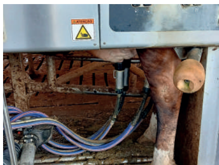
Figura 2 - Detalhe de um Robot de Ordenha em funcionamento numa vacaria comercial. Fotografia da autoria de André M. de Almeida.
